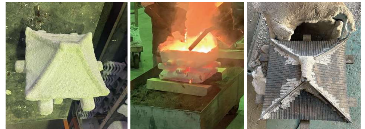
鋳造のプロセス 鋳型造形→鋳造→脱型
