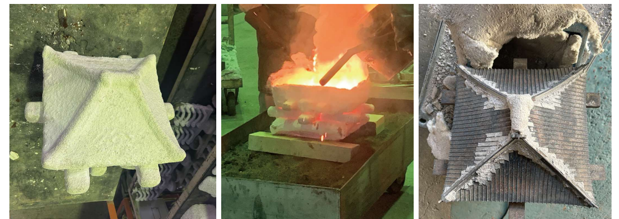
鋳造のプロセス 鋳型造形→鋳造→脱型
